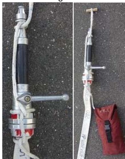
Bild 7 + 8: Mastwurf mit Halbschlag am CM-Strahlrohr mit Schlauch
