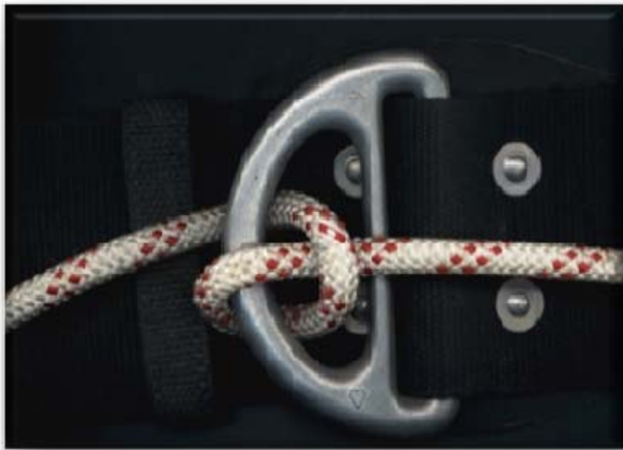
Bild 5: Halbmastwurf an der Öse
